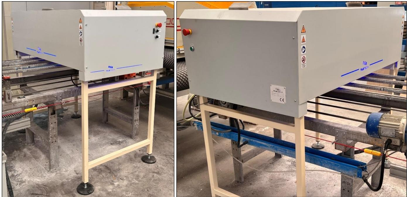
**Sahara** è forno compatto che opera in fase di asciugatura o essiccazione dei manufatti ceramici. In particolare, Sahara può essere utilizzato per asciugare la piastrella ceramica, per preparare la piastrella al trattamento dopo la lappatura e può essere anche un compattissimo essiccatore presso la linea di stuoiatura. Sahara si contraddistingue per l'elevata efficienza e non tralascia mai il risparmio energetico.
